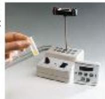
8. Retirez l'ampoule du bloc chauffant après le changement de couleur du témoin de contrôle négatif.
