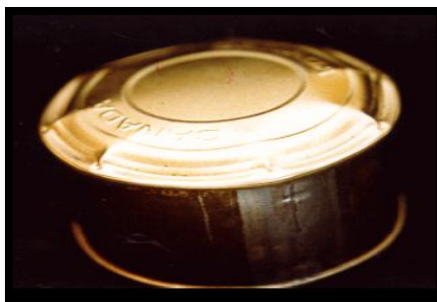
Figure 02 : Conserve bombée (Gignac et Duret., 2010).
