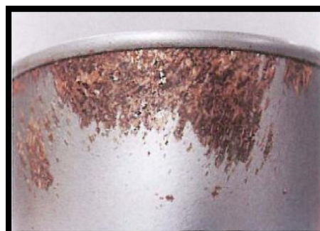
Figure 04 : Conserve rouillée au point d'entraîner un risque de perforation (Gignac et Duret., 2010).
