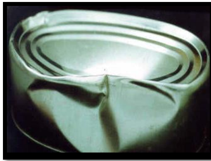
Figure 01 : Conserve écrasée au point d'empêcher son ouverture (Gignac et Duret., 2010).
