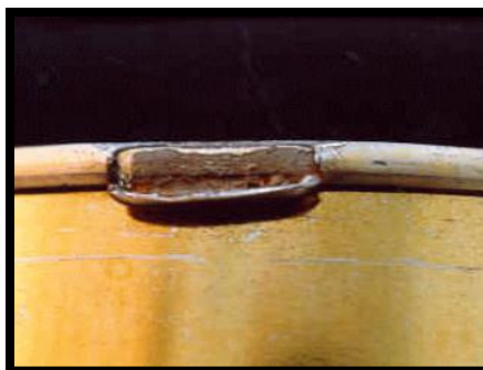
Figure 03 : Conserve avec défaut de formation du serti (Gignac et Duret., 2010).
