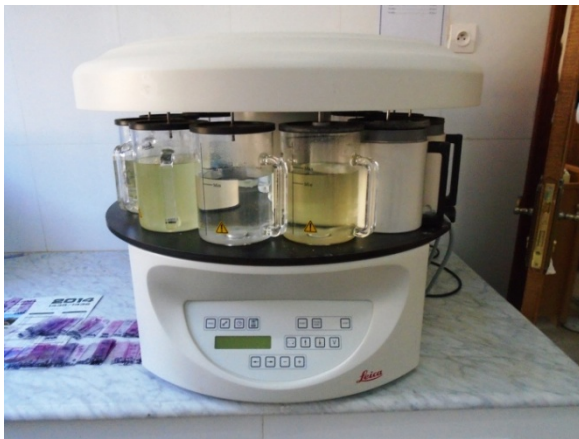
Figure 28 : Automate de déshydratation.
