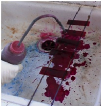
Figure 36 : Coloration par la fuchsin à chaud
