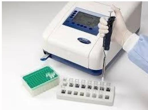
**Annexe 07 : (spectrophotomètre) [keison.com](http://keison.com)**
