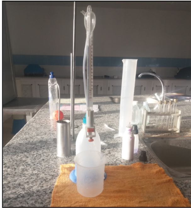
Figure 4 : Mesure de l'acidité : Titrage de NaOH avec lait et phynoftaline.
