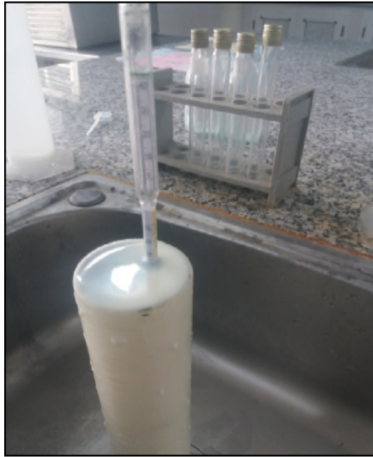
Figure 3 : Mesure de la densité et la température par lactodensimètre
