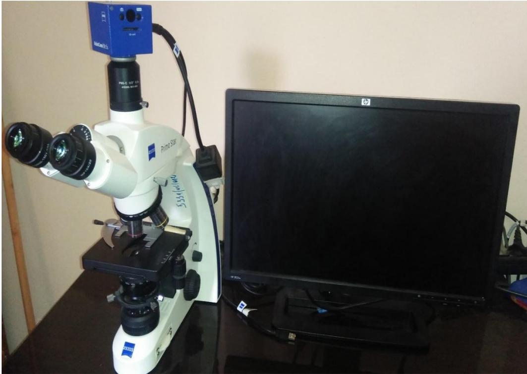
**FIGURE 17** : Microscope ZEISS PrimoStar muni d'une camera AxioCamEPC 5s
