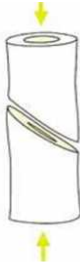
Figure N° 02:Fracture par compression (Roe, 1998).
