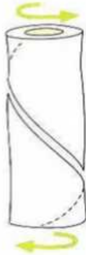
Figure N°03 : Fracture par torsion (Roe, 1998).
