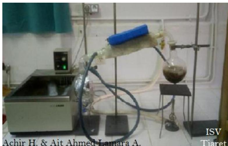
**Figure 3 : Dispositif d'hydrodistillation utilisé pour l'extraction des huiles essentielles.**
