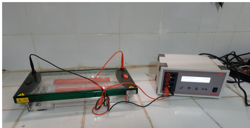
Figure 02 : Générateur et cuve d'électrophorèse et peignes (en rouge sur la photo)
