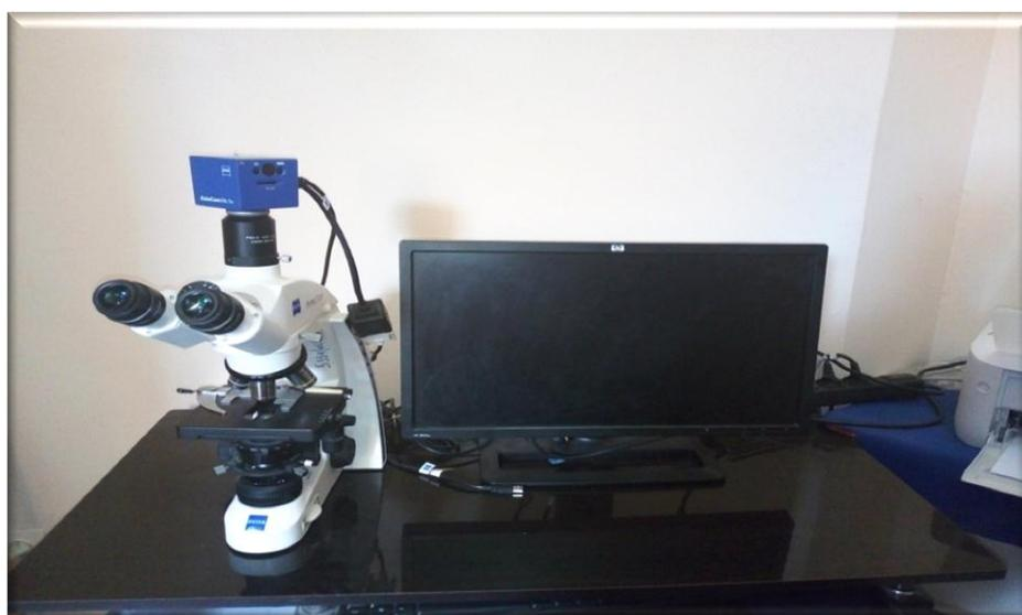
**Photo14 : Microscope lié à un appareil photo numérique**
