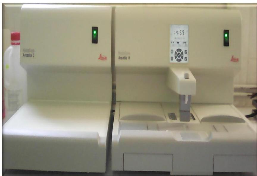
**Photo 11 :** Station d'enrobage de type Leica.
