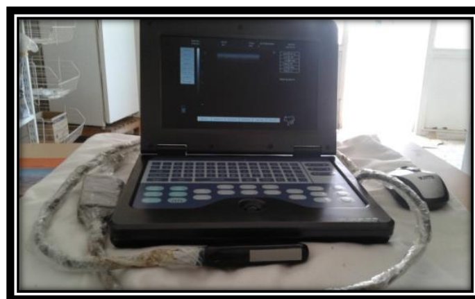
PhotoN°1 : Echographe de type « SIEMENS », la fréquence de l'appareil est 2 MHZ utilisé dans cette étude.
