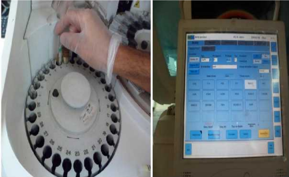
Figure.6 : Mise en place du plasma dans l'appareil du dosage puis lecture des résultats après 20minutes.
