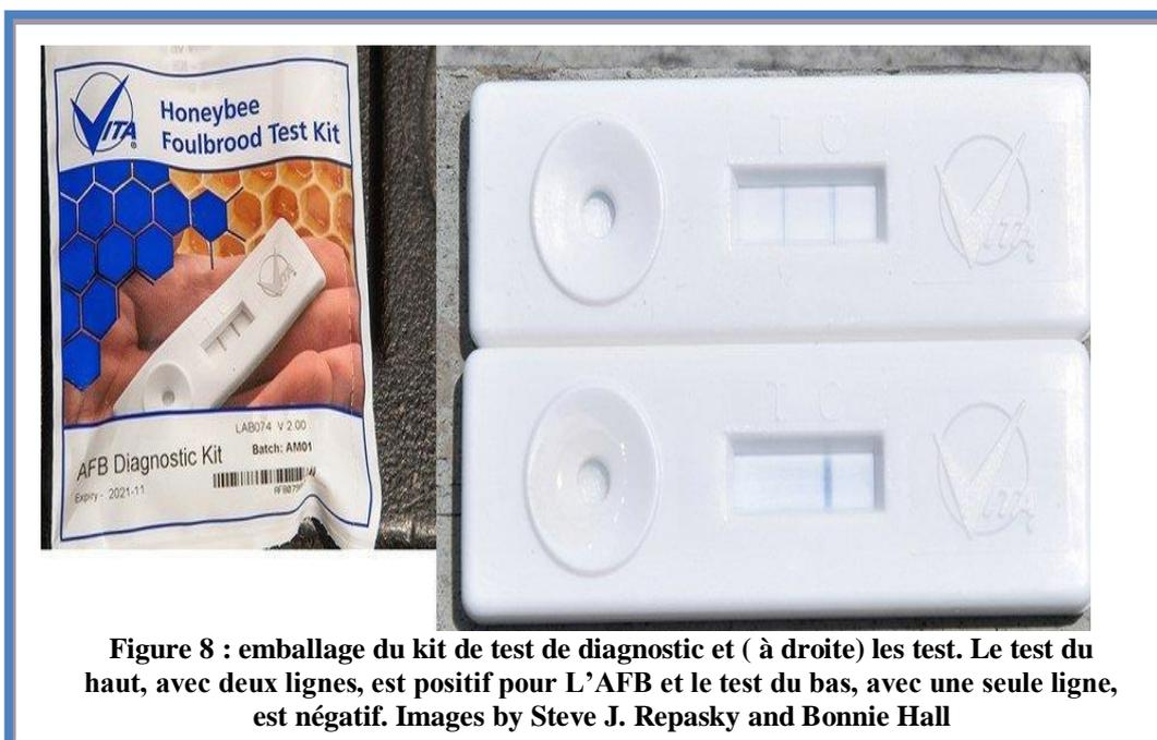
Figure 8 : emballage du kit de test de diagnostic et ( à droite) les test. Le test du haut, avec deux lignes, est positif pour L'AFB et le test du bas, avec une seule ligne, est négatif. Images by Steve J. Repasky and Bonnie Hall
