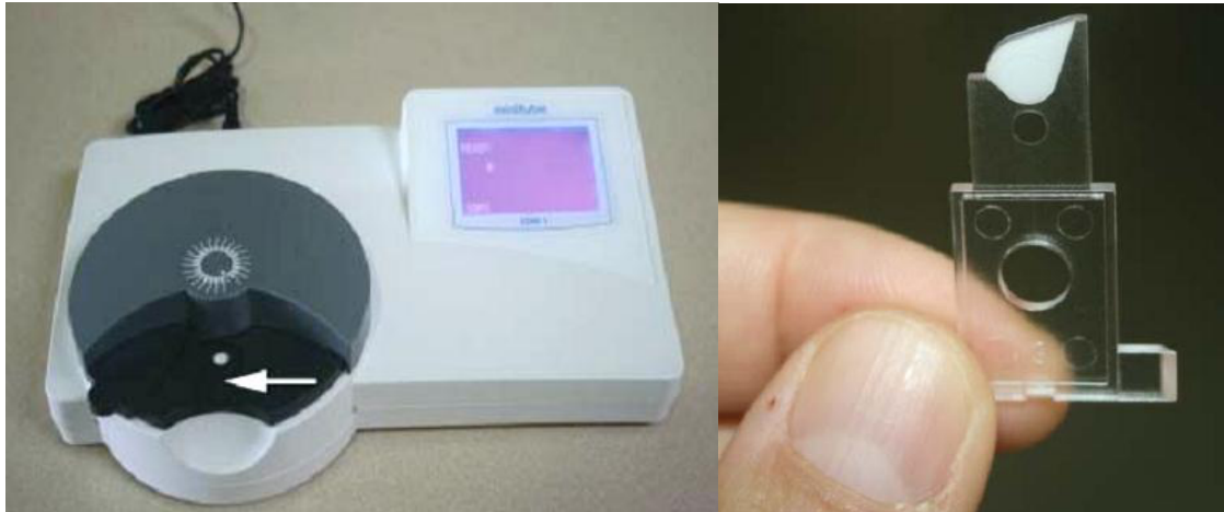
Figure 23 : Photomètre Minitube avec cuvette remplie en sperme (John Dascanio. 2014).
