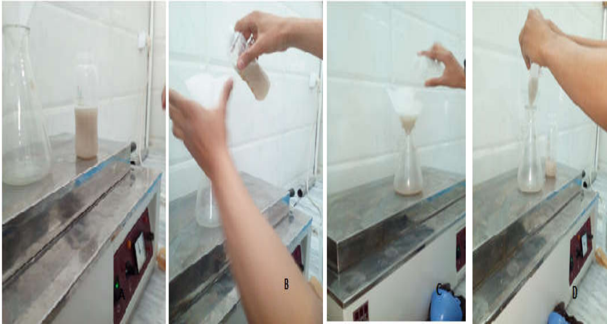
Figure32 : les étapes de filtration de la semence.
