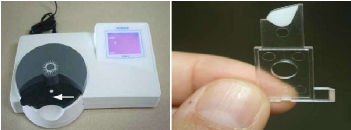
Figure15 : photomètre Minitube avec cuvette remplie en sperme (John Dascanio. 2014).
