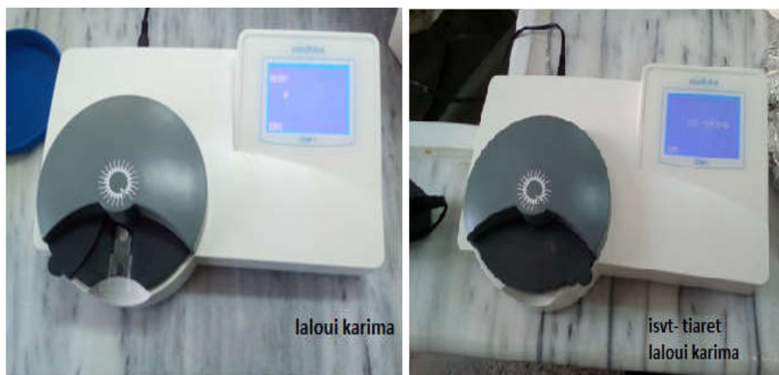
Figure 34: La détermination de la concentration à l'aide d'un photomètre Minitube.
