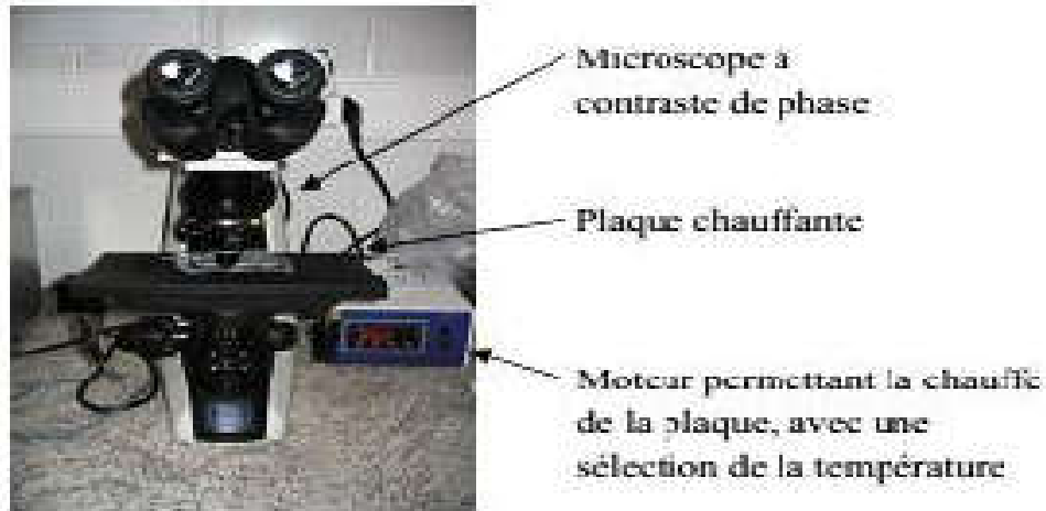
Figure 16 : microscope à contraste de phase muni d'une plaque chauffante (Marie Allimant, 2010.)
