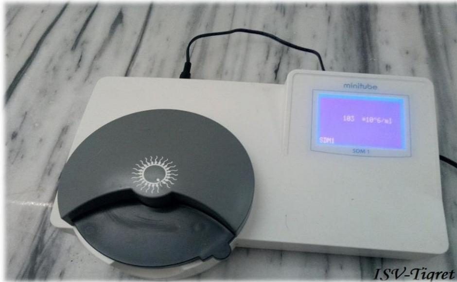
*Figure09 : un photomètre Minitube.*
