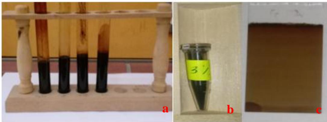
Figure III. 2: a- Gel de  $\text{MnO}_2$  dopé et non dopé ; b- Poudre de  $\text{MnO}_2$  ; c- Couche mince de  $\text{MnO}_2$ .
