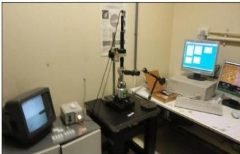
Figure III. 11: Microscope à force atomique (AFM).
