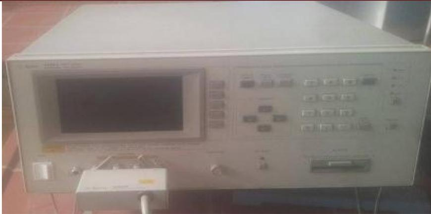
**Figure III. 13:** Spectroscopie d'impédance complexe AGILENT 4285A LCRMETER.
