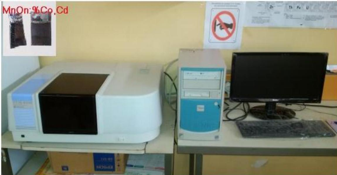
Figure III. 10: Spectromètre infrarouge SHIMADZU de type FTIR - 8400.
