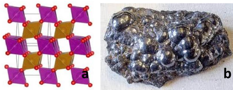
Figure I. 7 : (a) Structure cristallographique de la ramsdellite R-  $\text{MnO}_2$  et (b) sa morphologie [6].
