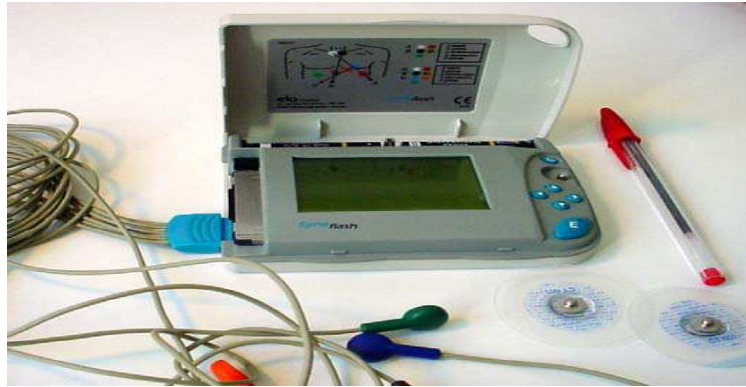
FIG 1.6: Enregistreur Syneflash® de la société Ela Medical . Le signal cardiaque enregistré pendant 24 heures est stocké sous forme numérique à 200Hz sur une carte à puce du type SanDisk ®. Cette carte est ensuite directement lisible sur un ordinateur PC et l'enregistrement peut être analysé avec le logiciel Synetec ® produit par la même société [Rém, 04].
