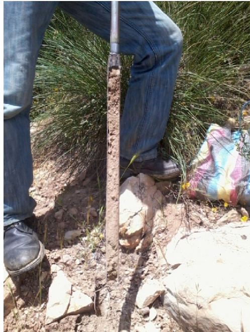
Figure n°21 : Prélèvement des échantillons du sol à l'aide de la tarière forestière pédologique (cliché AZZAOUÏ).
