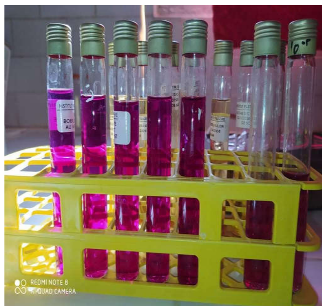
Bouillon BCPL pour le dénombrement des coliformes totaux
