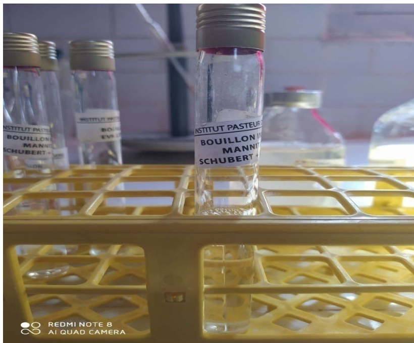
Bouillon Schubert pour le dénombrement des coliformes fécaux ( E-coli ).
