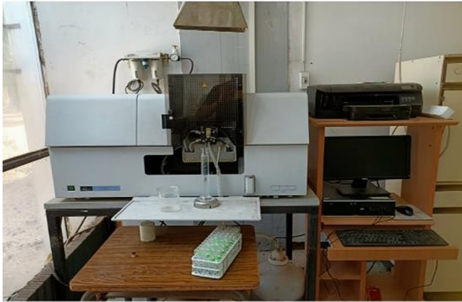
Figure 3 : Spectrophotomètre d'absorption Atomique utilisée durant notre étude (Photo originale).
