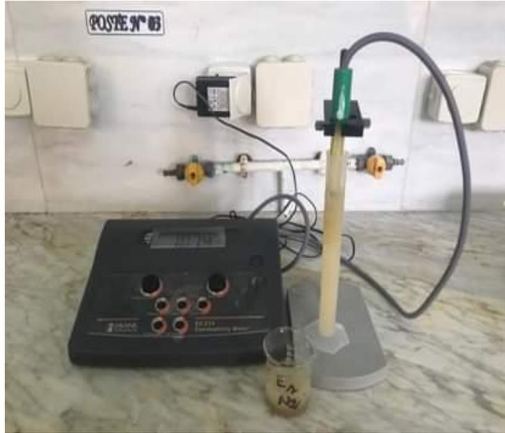
**Figure 13** : Mesure de la conductivité électrique du sol par le conductimètre (Cliche Djemil, 2021)
