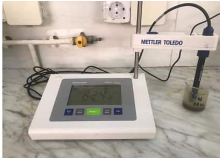
**Figure 12:** Mesure du pH d'un échantillon de sol à l'aide d'un pH mètre (Cliché Djemil, 2021)
