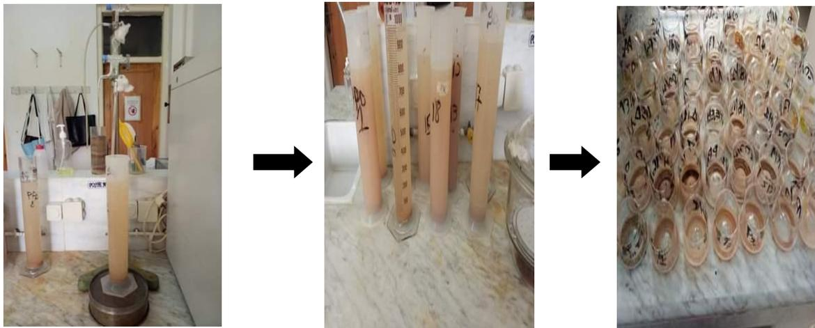
**Figure 11** : Analyse granulométrique par la méthode de la pipette de Robinson
