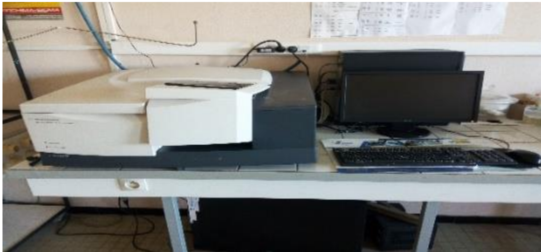
Figure II.5 : Spectrophotomètre infra rouge de type Shimadzu 8400.
