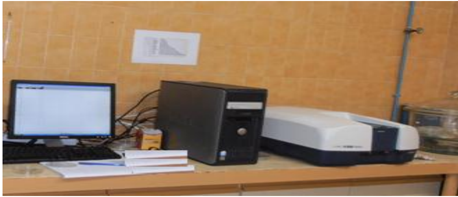
Figure II.9 : Spectrophotomètre UV/Visible de type Shimadzu CORP UV-1650PC.
