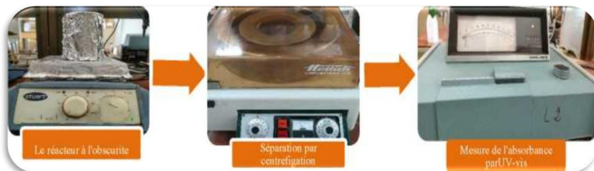
Figure IV-05 : Test d'adsorption, l'appareille centrifugeuse et UV-vis.(de la gauche à droite).
