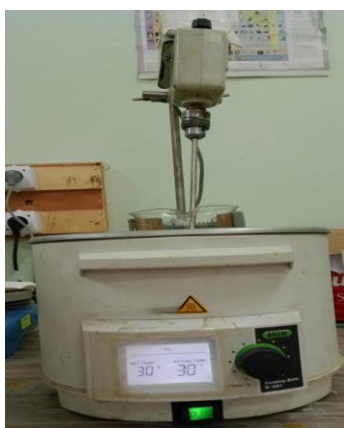
Figure II.2 : Dispositif expérimental de l'encapsulation par évaporation du solvant.
