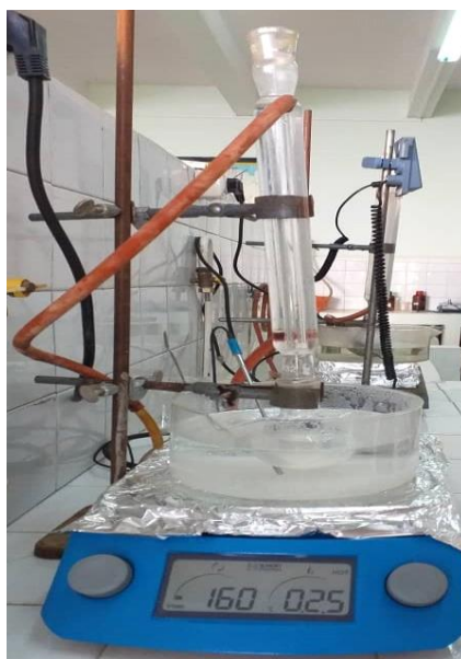
Figure II.1 : Montage a reflux pour réaliser la complexation
