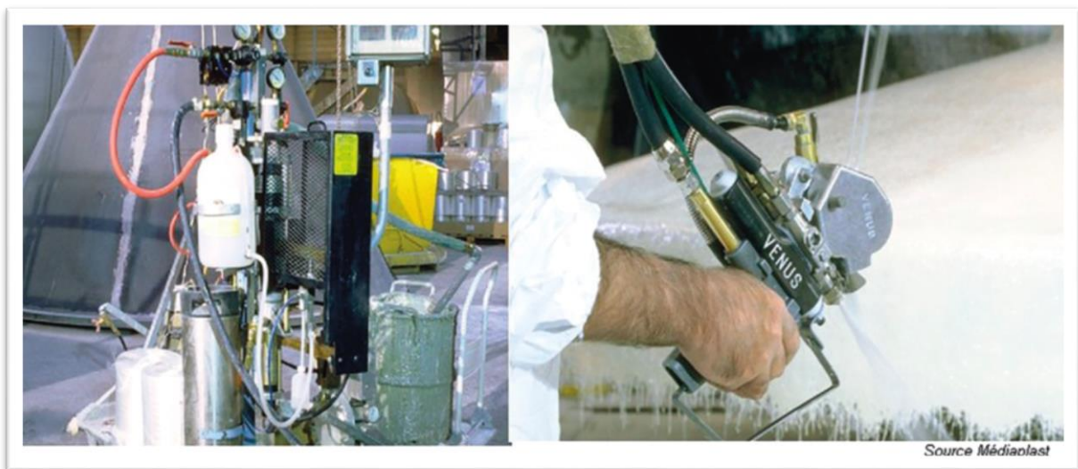
Figure I.12: Machine de projection simultanée.
