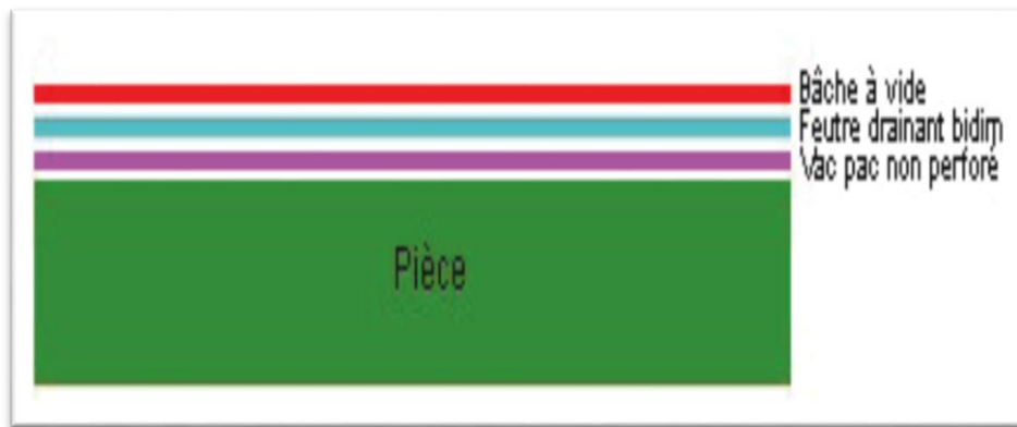
Figure I.13: Mise sous vide pour un thermoplastique.
