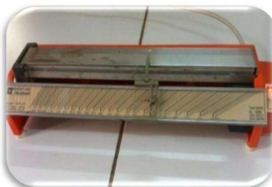
**Figure.51. L'appareil de banc de Koffler.**
