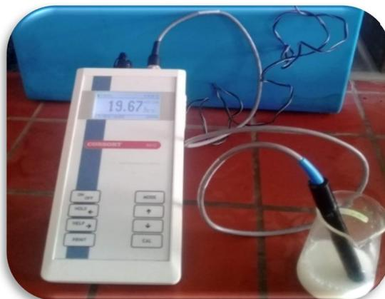
**Figure.53. La Conductimètre pour mesure la CMC**
