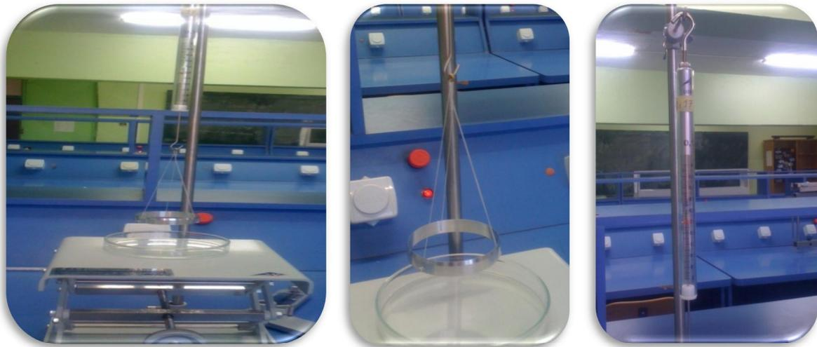
**Figure.52. Dynamomètre dispositif de calcul de la tension superficielle**
