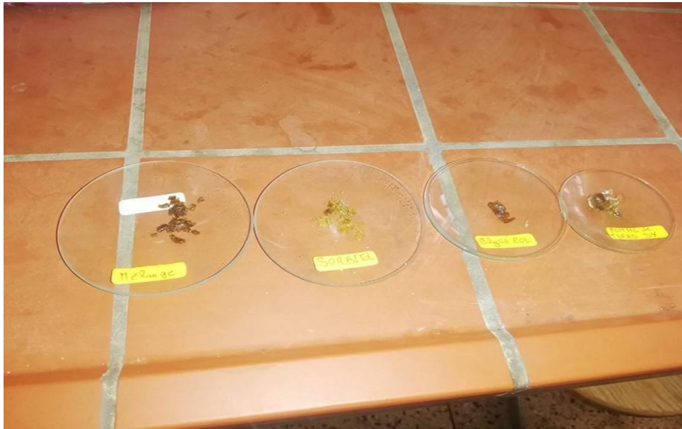
Figure. III.20 : Aspect physique lors de dégradation thermique des quatre matériaux.
