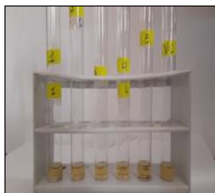
Figure 25 : Solution de DPPH du violet en jaune en fonction de la concentration
