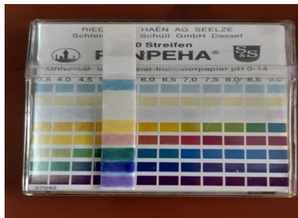
Figure 40 : mesure de PH par papier ph
