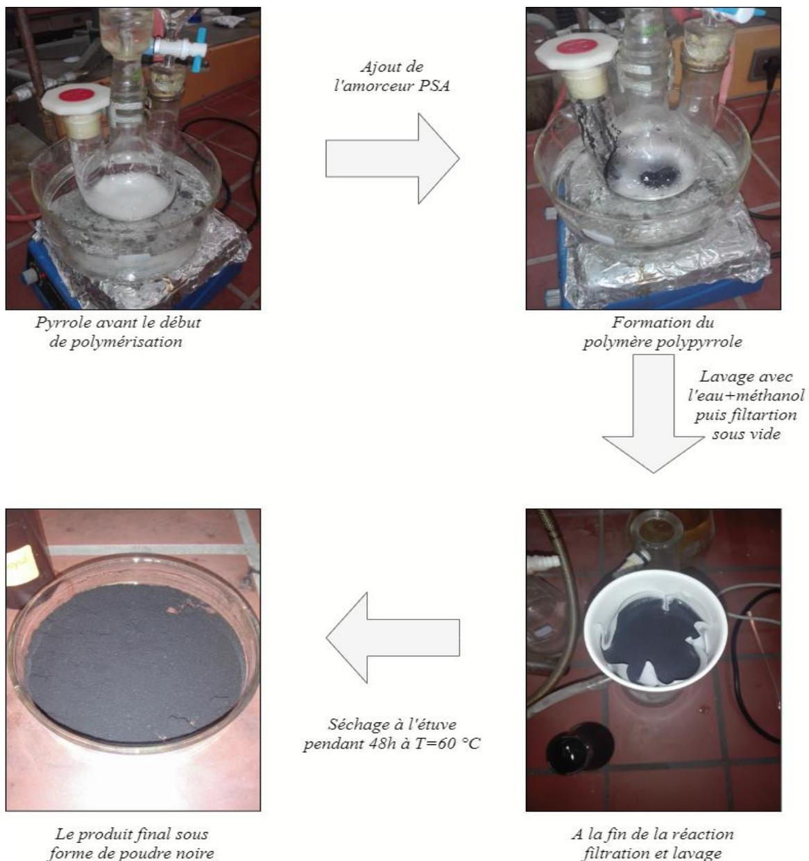
Figure II.2. Schéma représentant les étapes suivies lors de la synthèse du PPy et de composite PPy/TiO<sub>2</sub>.
