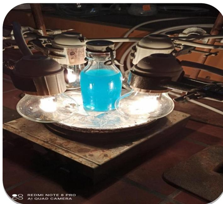
[Figure II.8 : Montage expérimental montre la photodégradation sans air]
