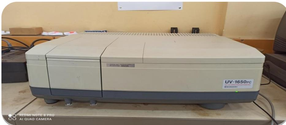
[Figure II.5 : UV-visible de marque (SHIMADZU 1650)]
