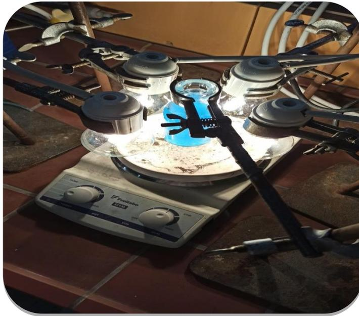
[Figure II.9 : Montage expérimental montre la photodégradation sans agitation]
