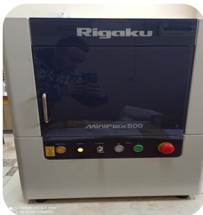
[Figure II.6 : Diffractomètre DRX de marque Mini Flex 600 Rigaku]
