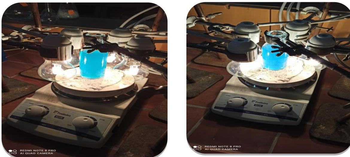
[Figure II.7 : Montage expérimental utilisé pour la photodégradation de bleu de méthylène]
