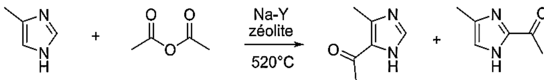
Figure II.25 : L'acylation du noyau imidazole sur le squelette carboné est réalisable par l'utilisation de la zéolite Na-Y. [39]
