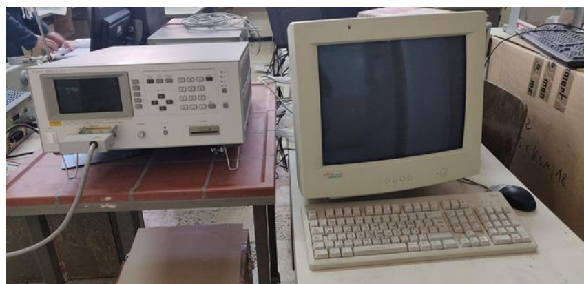
Figure III.2 : Montage du spectroscopie d'impedance pour les mesures diélectrique
