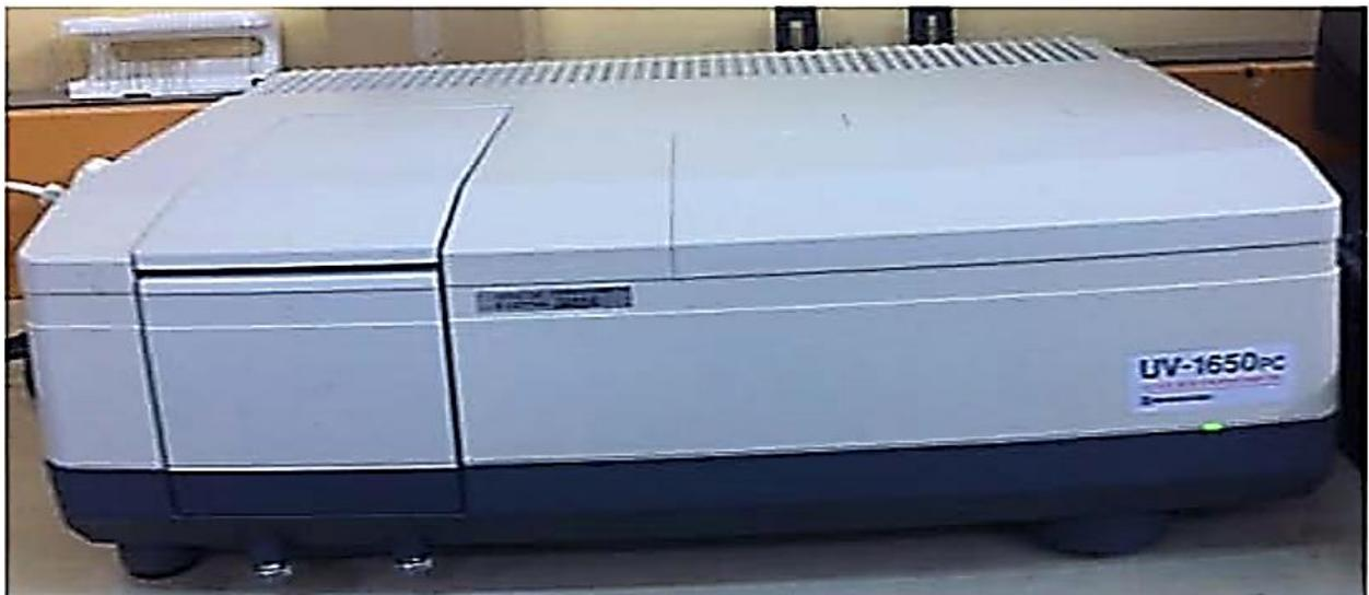
**Figure II.10:** Spectrophotomètre UV-Visible de marque SHIMADZU UV-1650-PC à double faisceaux.
