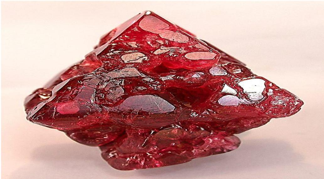
**Figure I.5:** Cristal du composé MgAl<sub>2</sub>O<sub>4</sub>.
