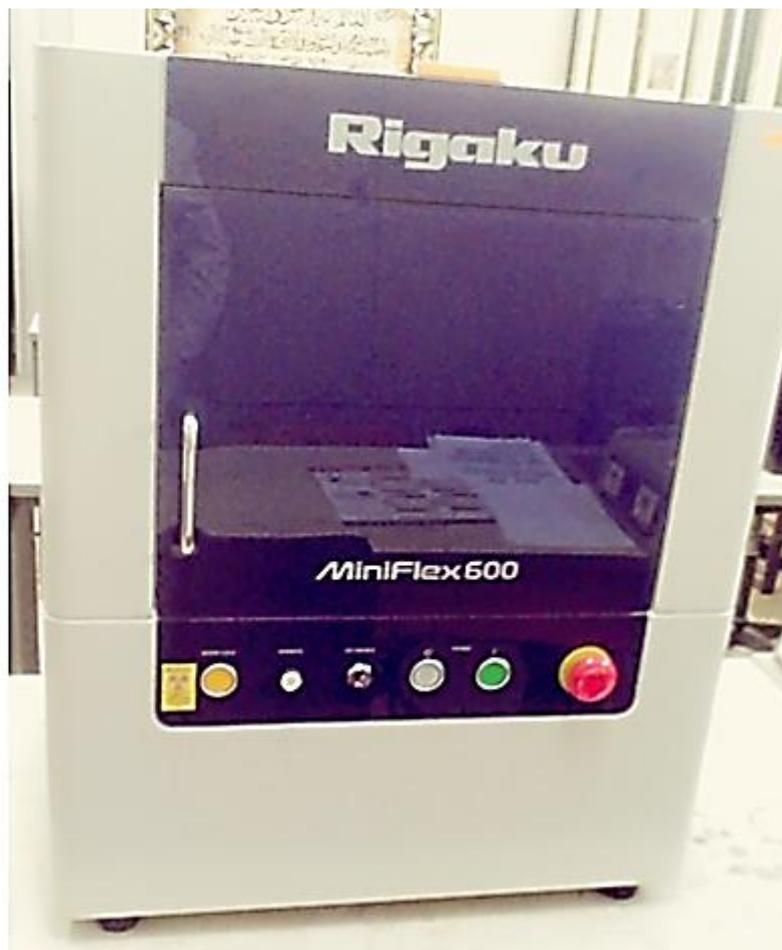
**Figure II.15:** Diffractomètre de rayon X.
