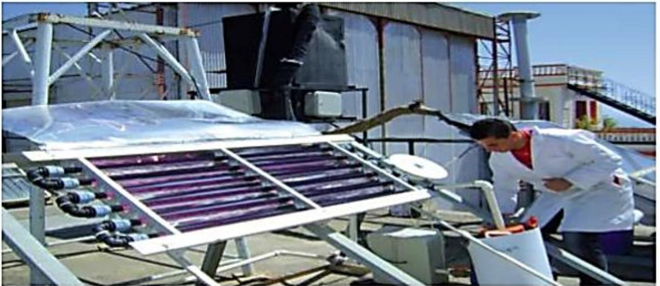
**Figure II.18** : Réacteur photocatalytique
