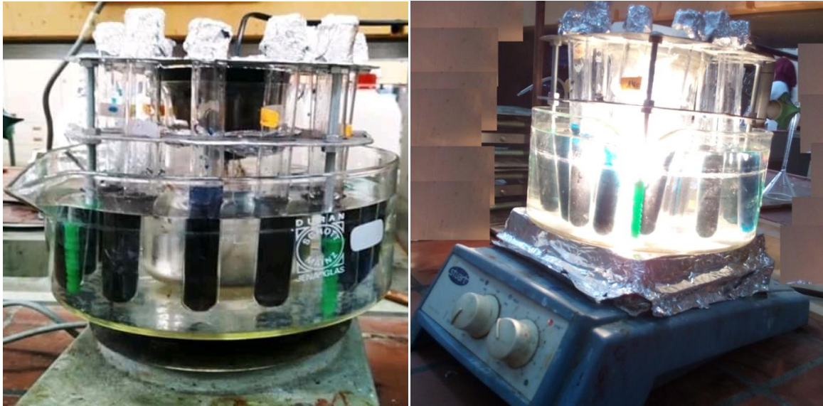
Figure III.32 : Montage du dispositif de dégradation
