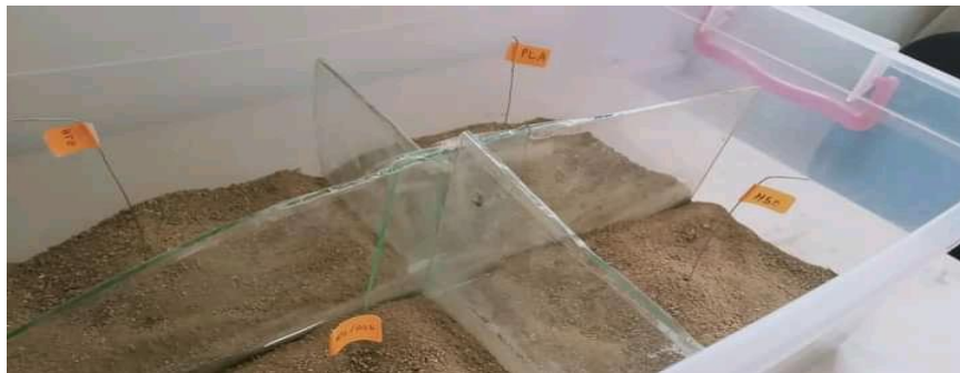
Figure I.2 : Essais d'enfouissement dans le sol
