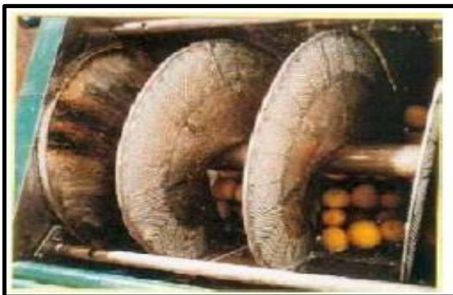
Figure 5: Extraction des huiles essentielles par expression ( BENETEAUD,2011).
