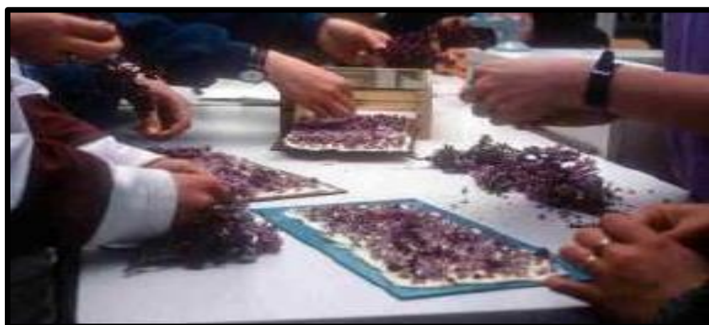
Figure 6: Extraction des huiles essentielles par enfleurage (LISAN,2014).
