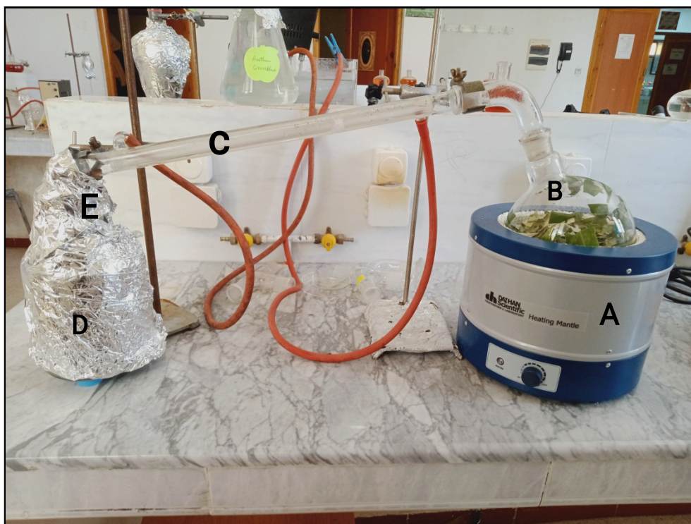
Figure 15 : Montage d'hydro distillation employé pour l'extraction d'huile essentielle : Clevenger
