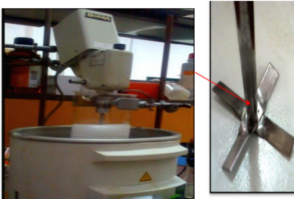
Figure 17: Dispositif expérimental de la synthèse des microsphères.
