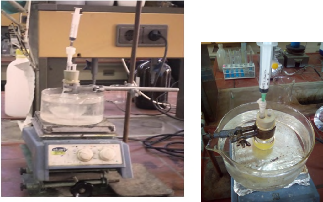
Figure 22: le dispositif expérimental de la libération du PA.
