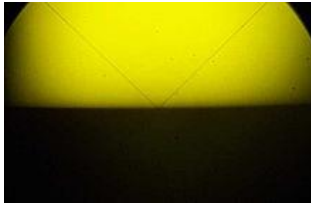
Figure 35: Réglage de la zone éclairée à la croisée des réticules
