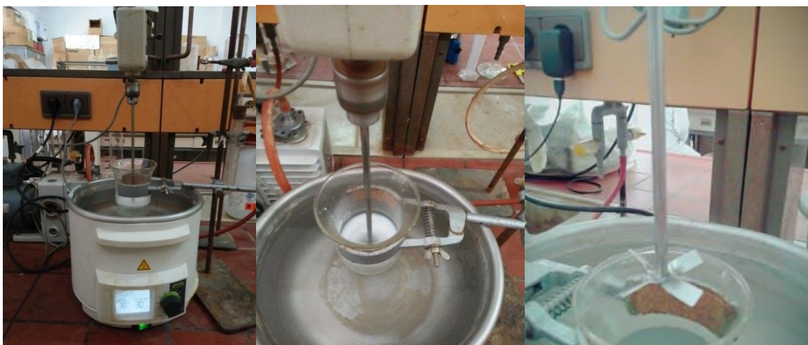
Figure 26 : Dispositif expérimental utilisé pour la microcapsulation par évaporation de solvant
