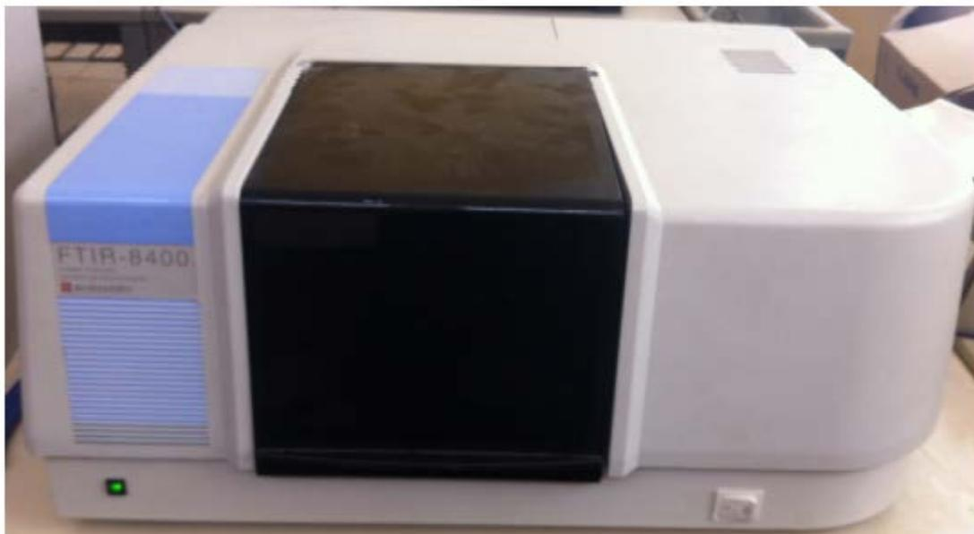
**Figure II.7 :** Spectrophotomètre SHIMADZU FT-IR-8400.
