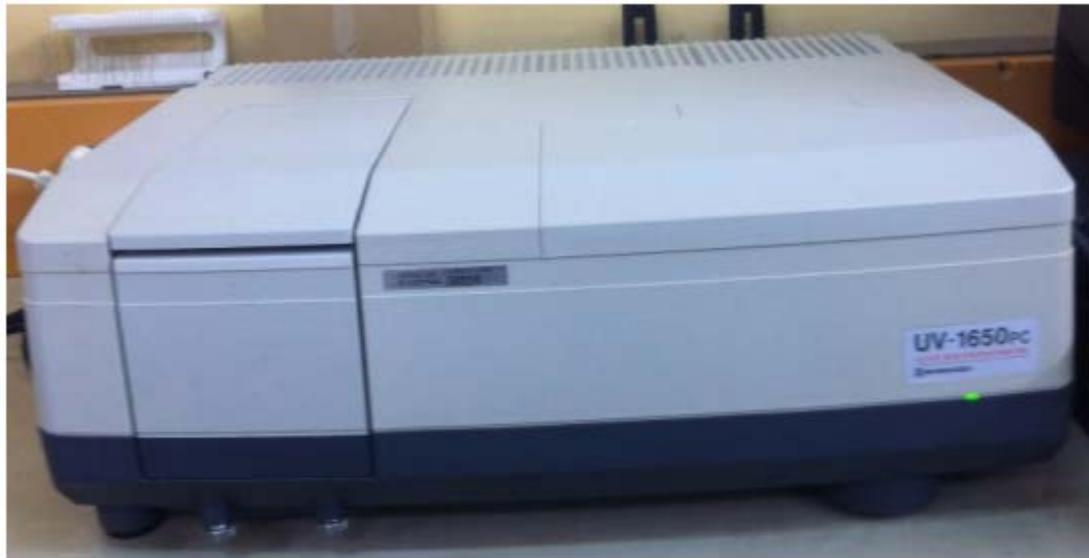
**Figure II.5:** Spectrophotomètre UV-Visible de marque SHIMADZU UV-1650-PC à double faisceaux.
