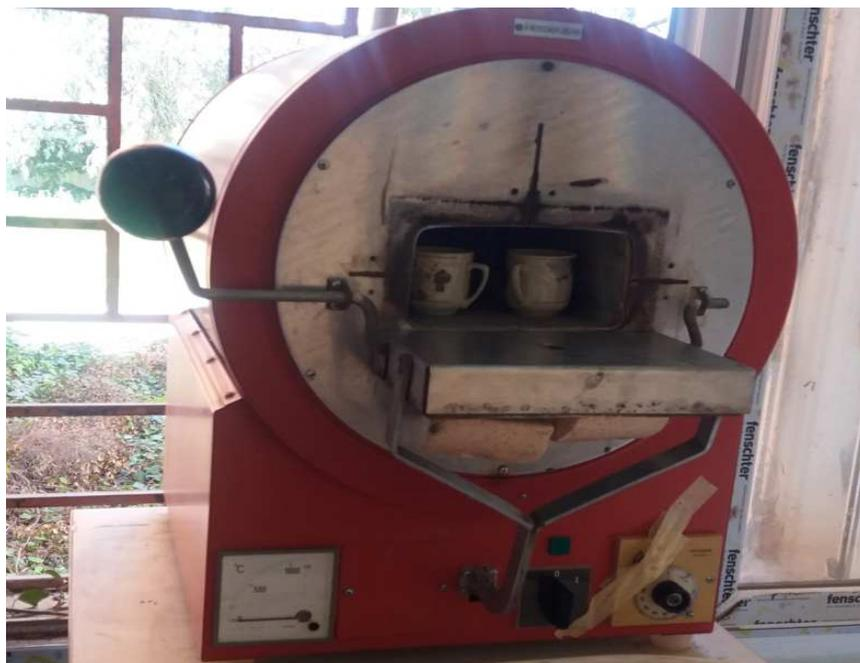
**Figure IV-5 :** Calcination des poudres pour la caractérisation DRX.
