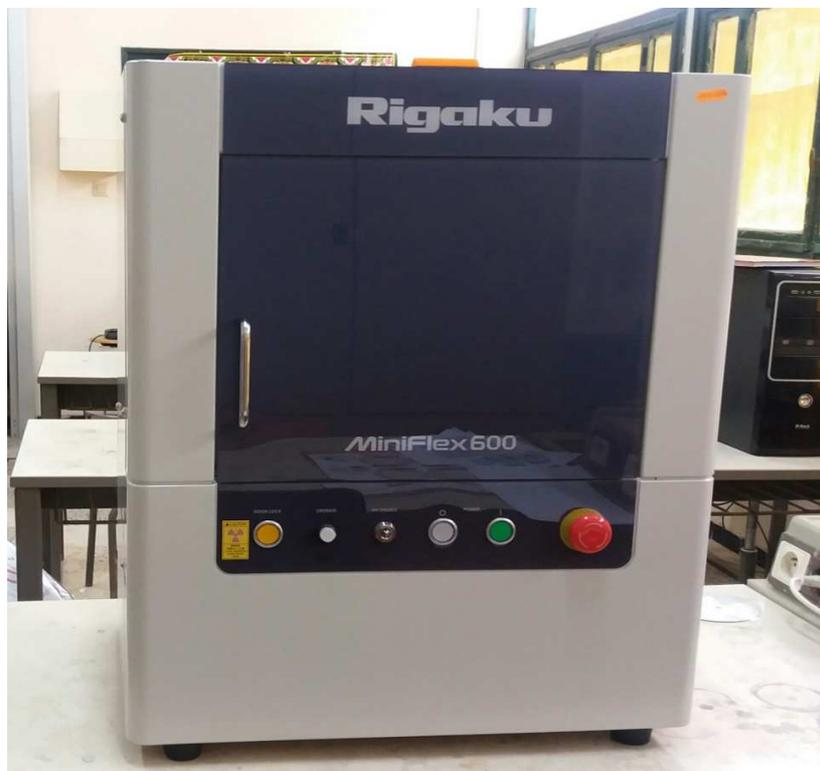
**Figure II-9** : Diffractomètre des rayons X de marque Rigaku MiniFlex- 600 W.
