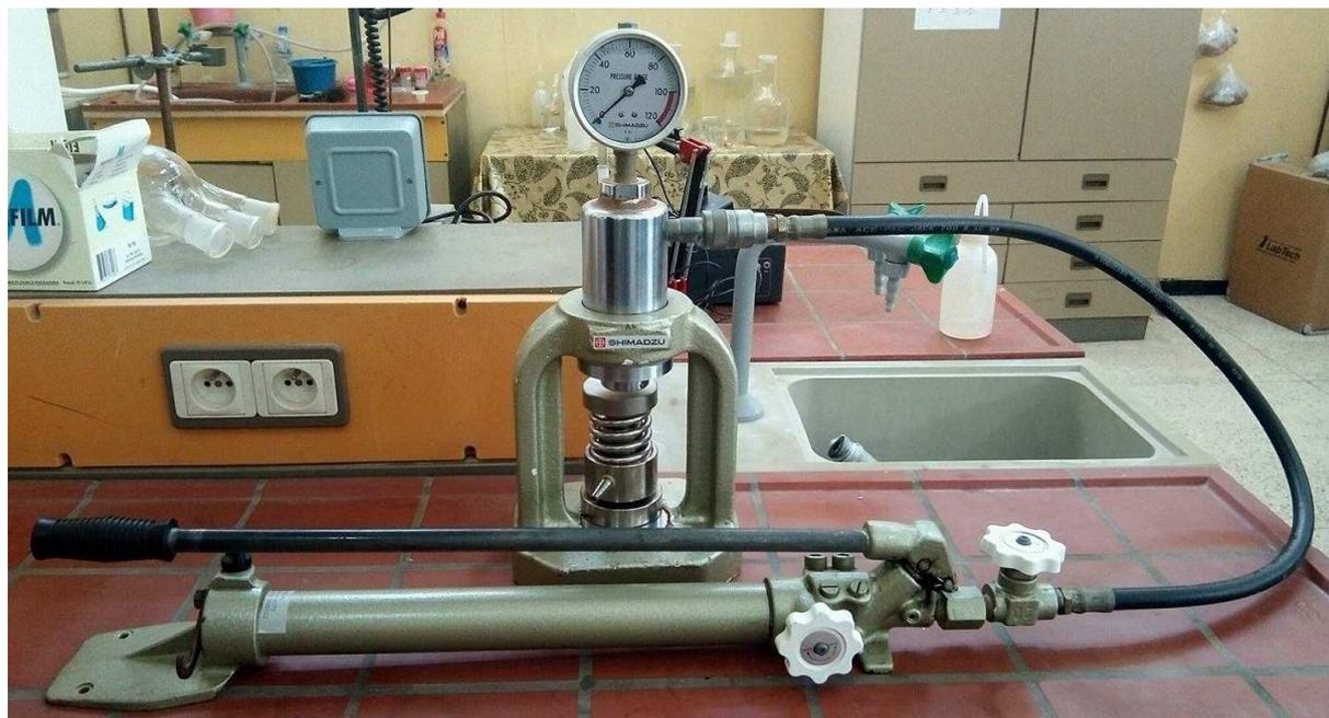
Figure IV-7 : pastilleuse pour compresser les échantillons.
