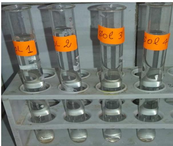
**Figure IV-2 :** Solutions du  $ZrO_2$  pur et dopée par différentes concentrations du  $Mn^{2+}$ .
