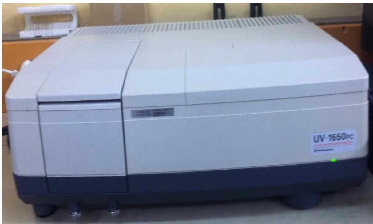
**Figure II-5** : Spectrophotomètre UV-Visible de marque SHIMADZU UV-1650-PC à double faisceaux.
