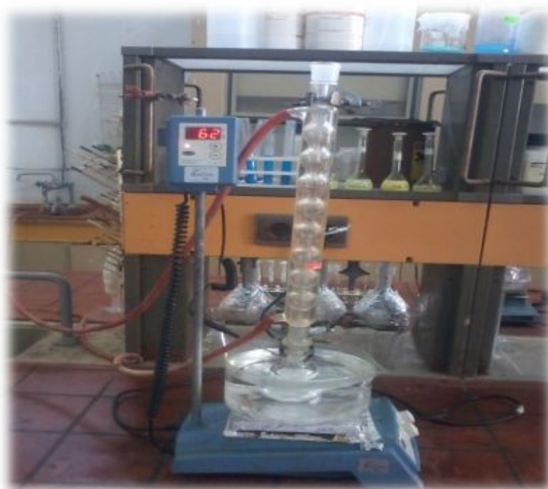
Figure II.1 : Le montage expérimental de la synthèse du Polyacrylamide
