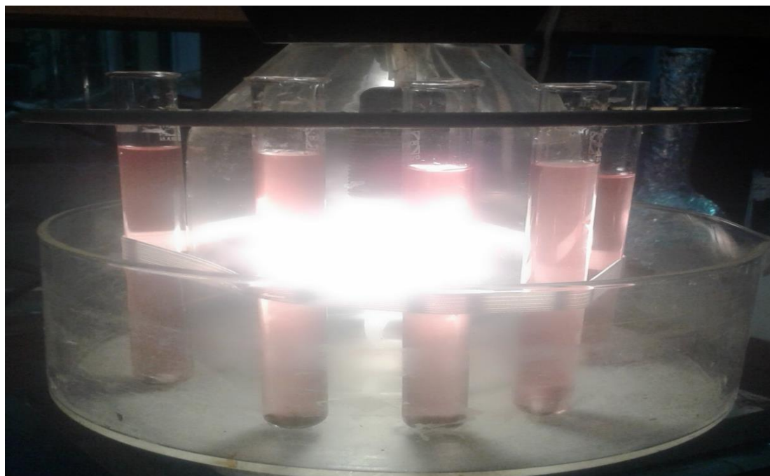
Figure III.43 : Montage du dispositif de dégradation
