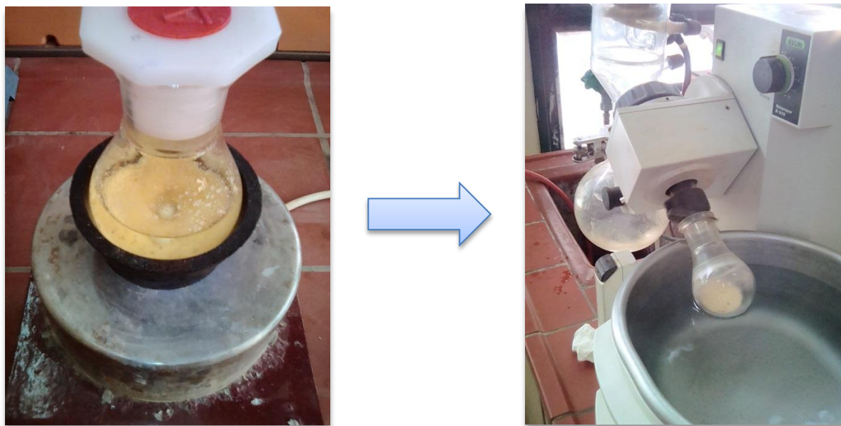
Figure III.5 : Lavage et purification d'iodure de 3-ethyl-methyl-1-méthylimidazol-3-ium
