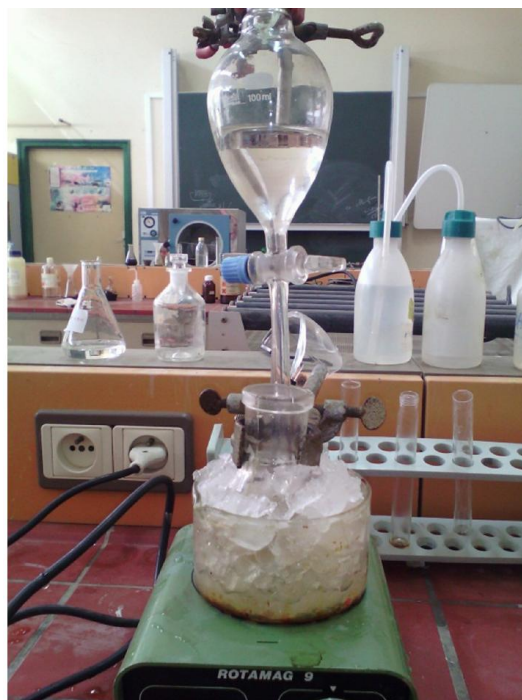
Figure IV.8 : La solubilisation de l'aniline dans un milieu acide.
