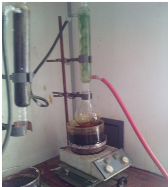
Figure IV.21 : Montage de la synthèse de LI.
