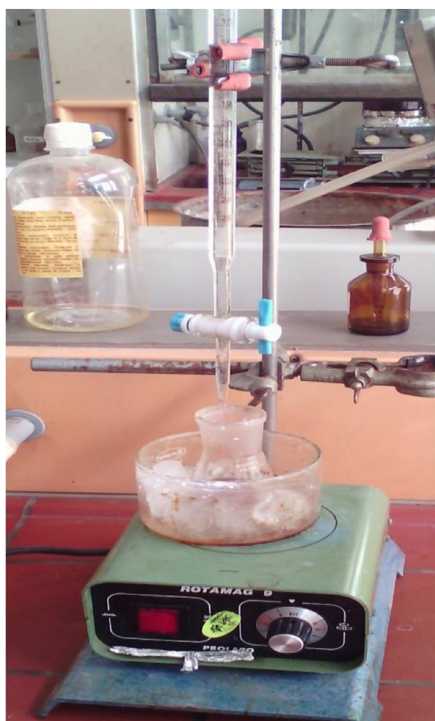
Figure IV.4 : Montage de la synthèse de produit en absence de LI.
