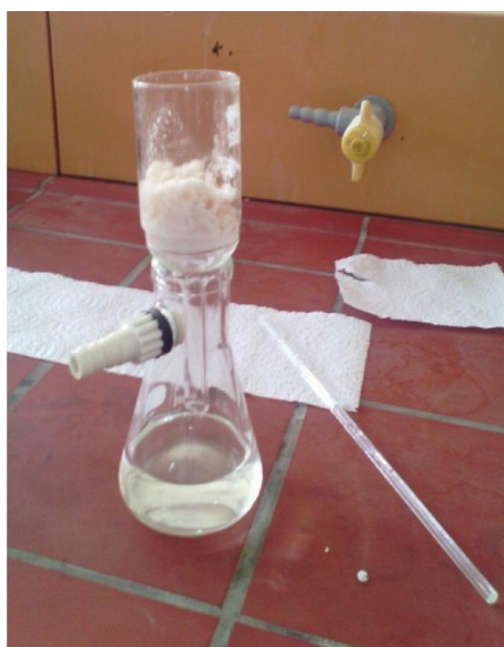
Figure IV.22 : Filtration du solide beige obtenu.
