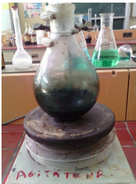
Figure IV.27 : Montage de synthèse de la PANI-ES en présence de LI.
