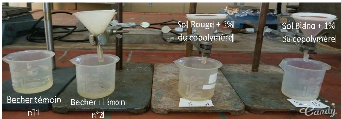
Figure IV.6 : Le protocole expérimental de mesure de la capacité de rétention et de filtration de l'eau du sol mélangé avec 1% du matériau copolymère
