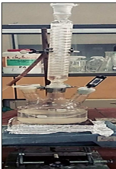
Figure II.1 : Le montage expérimental de la synthèse des copolymères
