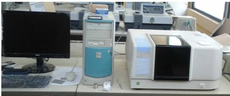
Figure II.5 : Spectrophotomètre Infra Rouge à Transformée de Fourier FTIR-8400S (SHIMADZU).
