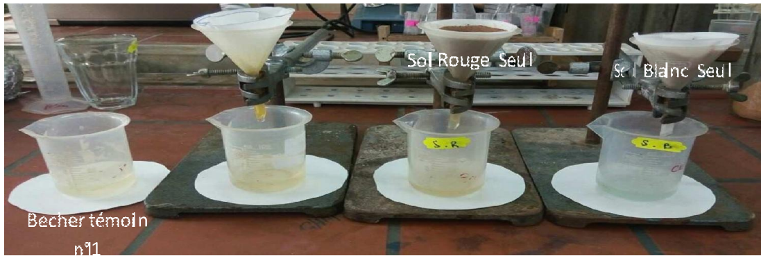
Figure IV.5: Le protocole expérimental de mesure de la capacité de rétention et de filtration de l'eau du sol seul
