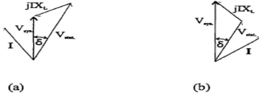
Fig.III.4 Diagrammes vectoriels de fonctionnement d'un ASVC réel
