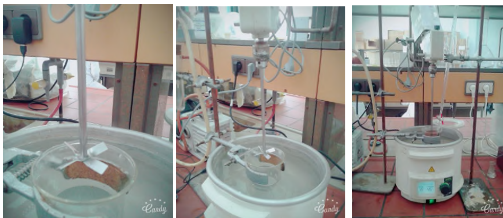
Figure II.6 : Dispositif expérimental de l'encapsulation par évaporation de solvant.
