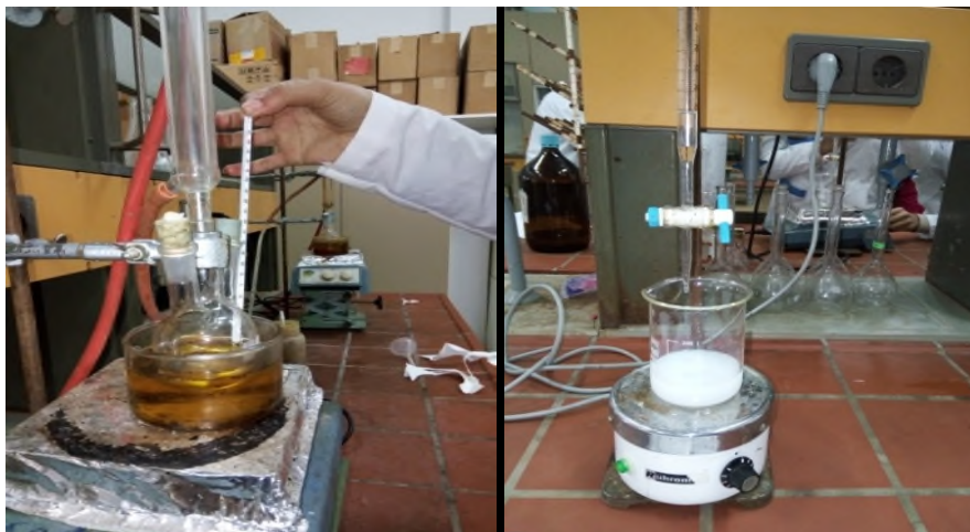
Figure II.3: Etapes de polymérisation du styrène.
