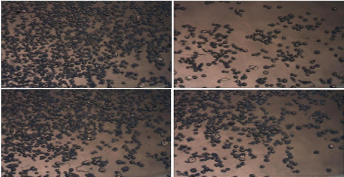
**Figure III.2 :** Observation des microsphères de PCL(M1) par microscope optique
